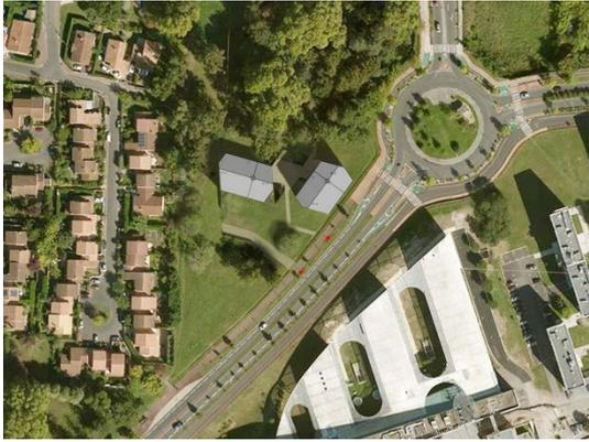
Les deux bâtiments sont de hauteurs différentes. Cette différence de hauteur a été pensée de façon à assurer une parfaite insertion du projet dans le site, et à éviter les ombrages des bâtiments sur les parcelles voisines. Le bâtiment situé à l'ouest du terrain est en R+3/R+4 étages. Il abrite 18 logements. Cette hauteur lui permet d'éviter totalement, y compris en hiver, de projeter des ombres portées sur les maisons situées à l'ouest du terrain.
