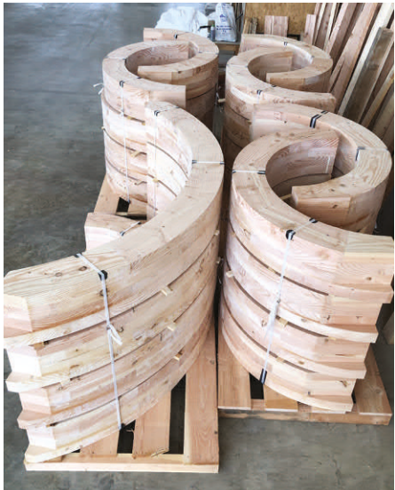
Linteaux cintrés fabriqués par le charpentier 2023 ■ ©Charpentiers du Haut Beaujolais
