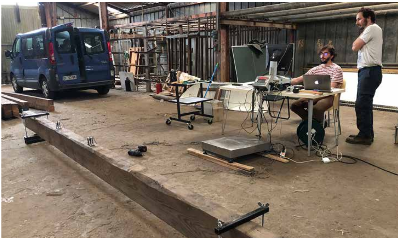
Caractérisation à l'ultra son des bois de réemploi structurel.
