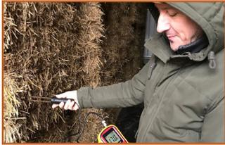
Le projet est pionnier, construire une usine de métallerie en paille. (photo test humidité paille)
