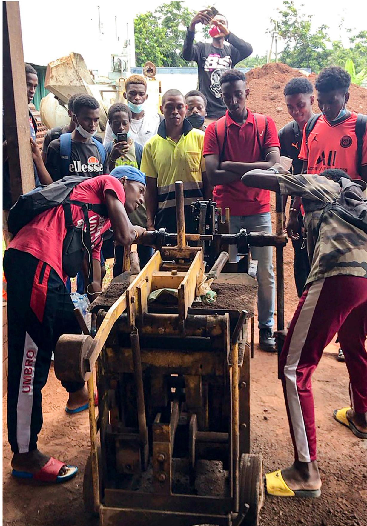
À Mayotte, le chantier du Faré du lycée a servi d'atelier pour l'apprentissage de la fabrication des blocs de terre comprimée (BTC).
